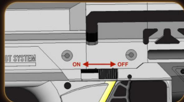
Chcete-li zbraň zajistit, posuňte tlačítko pojistky dopředu. Chcete-li ji odjistit, posuňte tlačítko dozadu.
