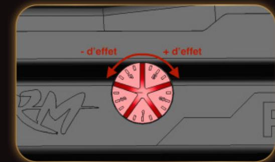
Nastavení hop up umožňuje ovlivnit trajektorii kuliček. Bude nutné provést úpravu v závislosti na hmotnosti používaných kuliček. Nastavení se provádí ve 20 polohách pomocí kolečka umístěného na boku zbraně. Otáčením kolečka hopup ve směru hodinových ručiček zvýšte hop up efekt a proti směru hodinových ručiček ho snížíte.
